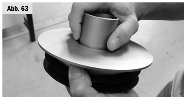
Abb. 63 4. Um den Füllstand zu verändern, nehmen Sie den Überlaufstopfen aus dem Ablauf und verdrehen das herausstehende Rohr gegen den Dichtungsteller. Drehen Sie das Rohr gegen den Uhrzeigersinn heraus, um den Füllstand zu erhöhen. Drehen Sie das Rohr im Uhrzeigersinn hinein, um den Füllstand zu senken. Testen Sie eine neue Einstellung und achten Sie dabei darauf, dass die Wanne nicht überläuft.
