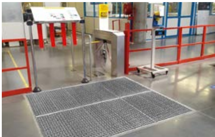
Limpeza de suelas y ruedas por ProfilGate® st55 go antes de zonas ESD
